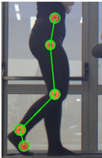
Rys. 6.3. Wizualizacja zaproponowanego modelu identyfikacji zaimplementowana przy użyciu biblioteki OpenCV. Opracowanie własne.
