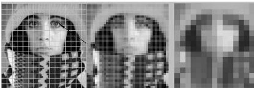
Rys. 18. Etapy próbkowania i kwantyzacji obrazu cyfrowego.
