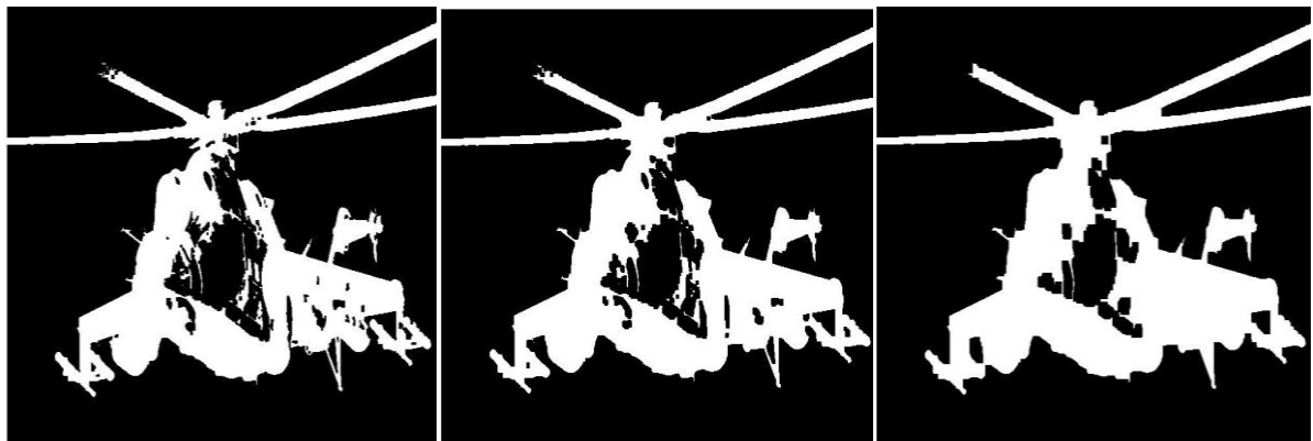
Rys. 52. Przykłady operacji zamknięcia kolejno z progami 5/5, 15/15, 20/20.
