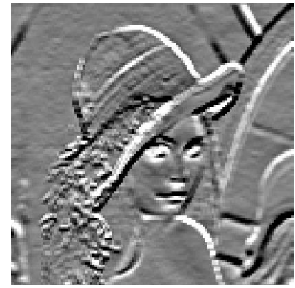
Rys. 40. Filtr górnoprzepustowy z użyciem pionowej maski Prewitta.
