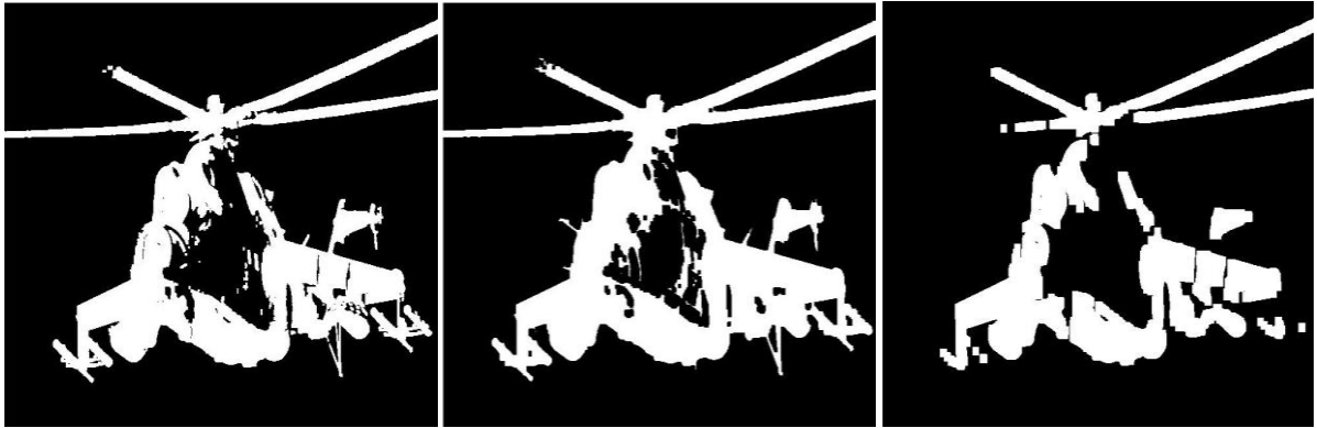
Rys. 51. Przykłady operacji otwarcia kolejno z progami 5/5, 15/15, 20/20.
