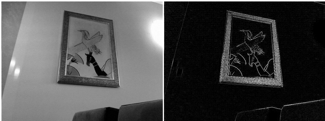
Rysunek 20 Zastosowanie filtru Laplace'a do wykrywania krawędzi
