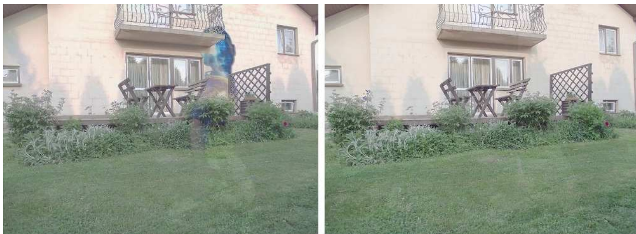
Rysunek 5.6. Obraz HDR przed (po lewej) i po usunięciu ruchu (po prawej), opisane w tabeli 5.1 jako „ogród”.
