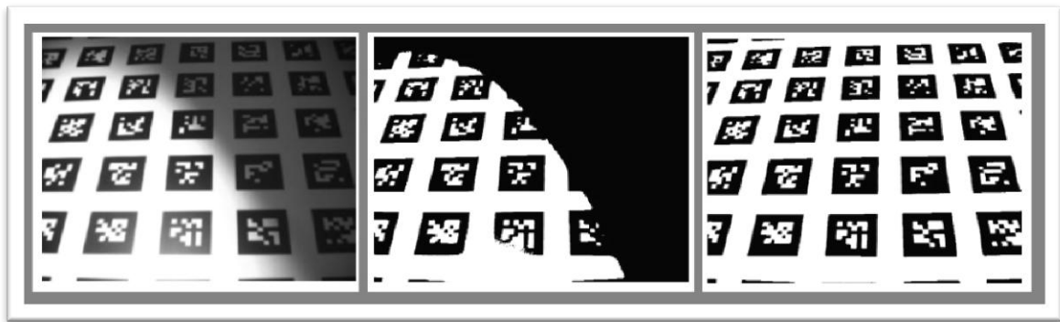
Rys. 3.8. Obraz wejściowy (po lewej), binaryzacja ze stałym progiem (środkowe), progowanie adaptacyjne (po prawej). Źródło [16].
