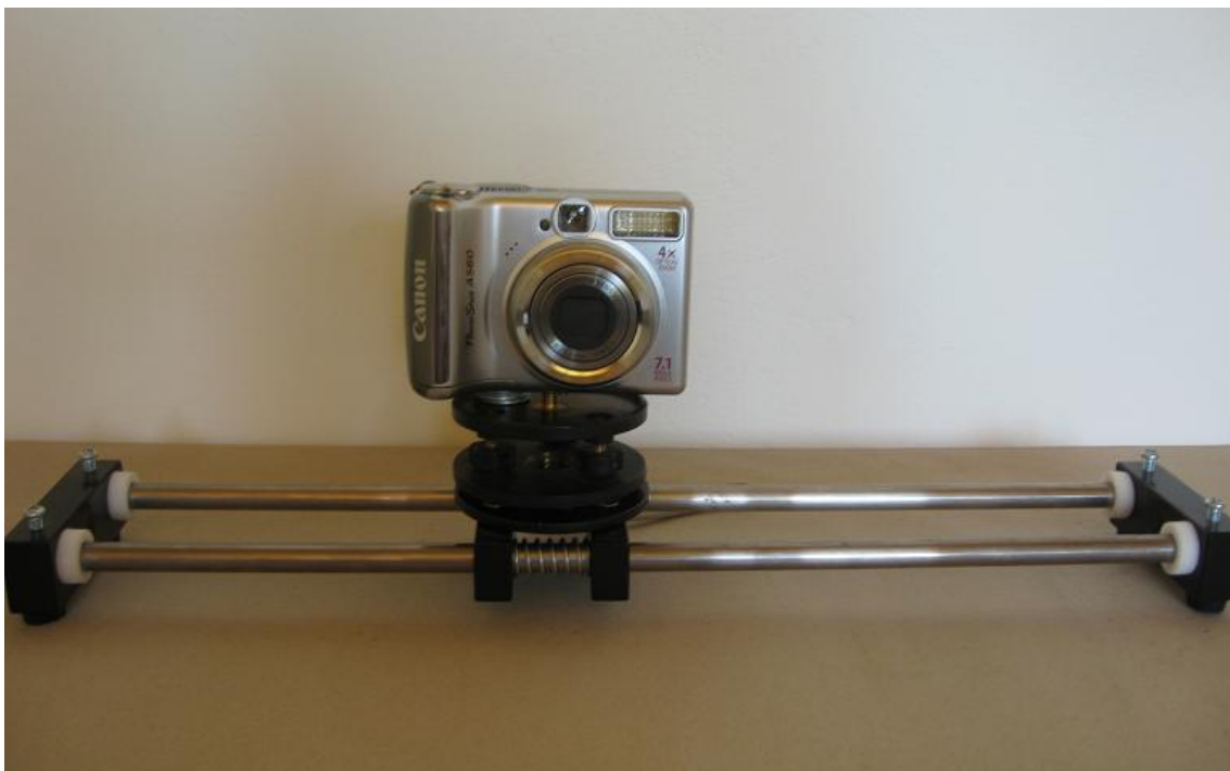
Rysunek 4.1: Wyposażenie umożliwiające wykonywanie zdjęć stereoskopowych
